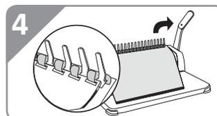
4. Верните рабочую ручку в исходное положение "Вверх". Снимите готовую брошюру с переплетного механизма.
