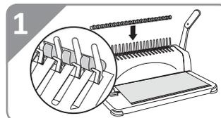
1. \*Выберите пружину нужного диаметра, используя таблицу соответствия. Поместите пружину за держатель переплетного механизма зубцами вверх.
