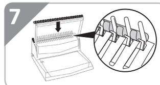
7 Выберите пружину нужного диаметра, используя таблицу соответствия. Поместите пластиковую пружину за держатель переплетного механизма зубцами вверх.
