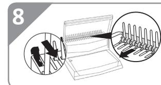
8 Потяните ручку фиксации пружины на себя, чтобы открыть пластиковую пружину.
