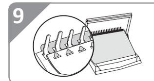
9 Вставьте пробитые листы непосредственно в открытую пластиковую пружину. Начните с передней обложки документа.
